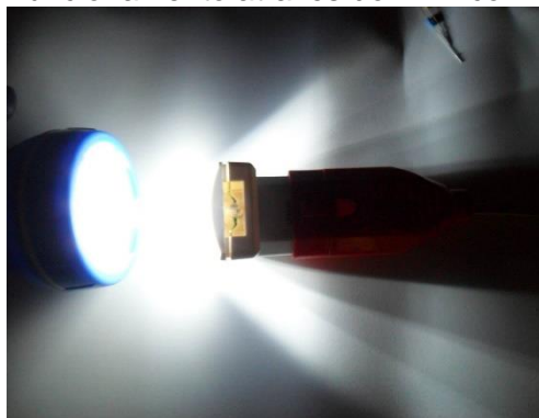
Figura 4: Dispositivo com funcionamento através do LDR com incidência de luz sobre ele
